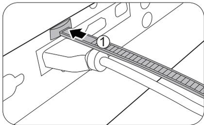
2. Возьмите замок кабельной стяжки. Немного откройте замок, чтобы он обхватил соединительный кабель.
