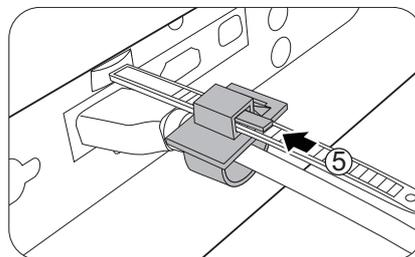
L'installazione del ferma cavi è completata.
