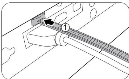
2. Afferrare l'elemento di fissaggio ferma cavi. Aprire leggermente l'elemento di fissaggio per avvolgere il cavo di collegamento.
