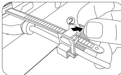
3. Вставьте конец кабельной стяжки в замок кабельной стяжки, как показано.
