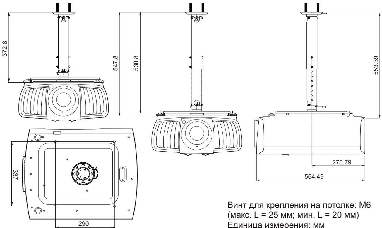
Винт для крепления на потолке: М6
