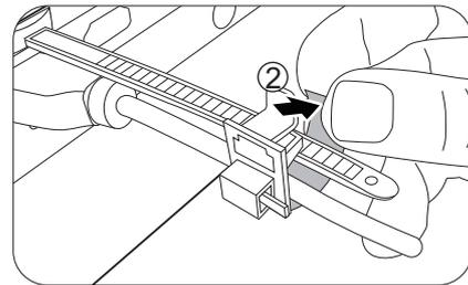
3. Fügen Sie ein Ende des Kabelbinders in die Kabelbinderklemme wie abgebildet ein.
