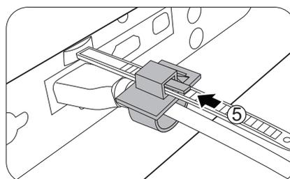
L'installation de l'attache de câble est finie.
