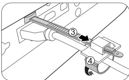
5. Spostare l'elemento di fissaggio lungo il ferma cavi fino alla presa del cavo.
