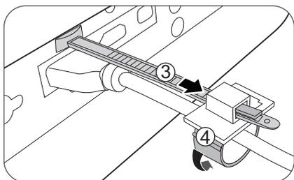
5. Сдвиньте замок кабельной стяжки вдоль кабельной стяжки к концу штекера кабеля.
