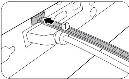
2. Nehmen Sie die Kabelbinderklemme. Öffnen Sie die Klemme etwas, um das Anschlusskabel zu umschließen.
