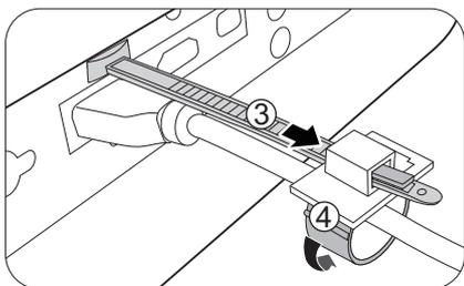
5. Déplacez le cliquet d'attache de câble avec l'attache de câble à l'extrémité de la prise du câble.
