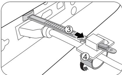
5. Verschieben Sie die Kabelbinderklemme am Kabel bis zum Ende des Kabelsteckers.
