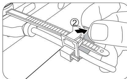
3. Insérez l'extrémité de l'attache de câble dans le cliquet d'attache de câble, comme illustré.
