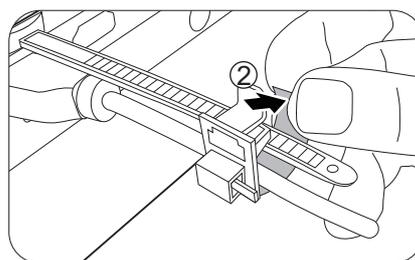
3. Inserire l'estremità del ferma cavi nell'elemento di fissaggio ferma cavi come illustrato.
