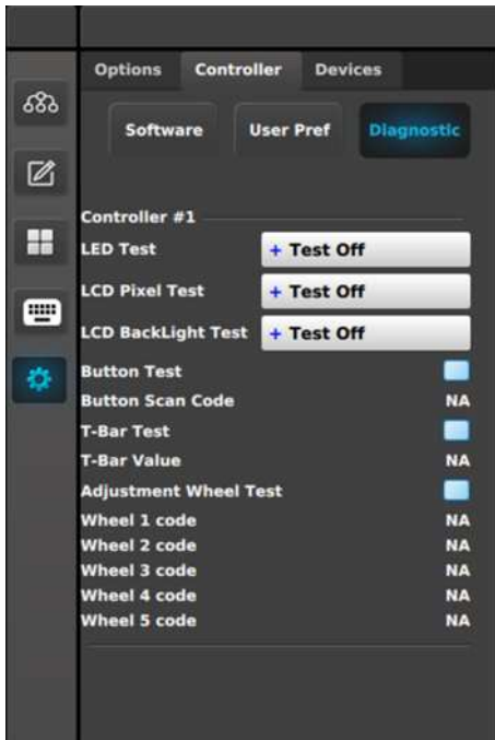
Controller tab: Diagnostic subtab
