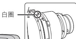
④ 將鏡頭的白環朝上，再將鏡頭組件直接插入鏡頭的插入部位。
