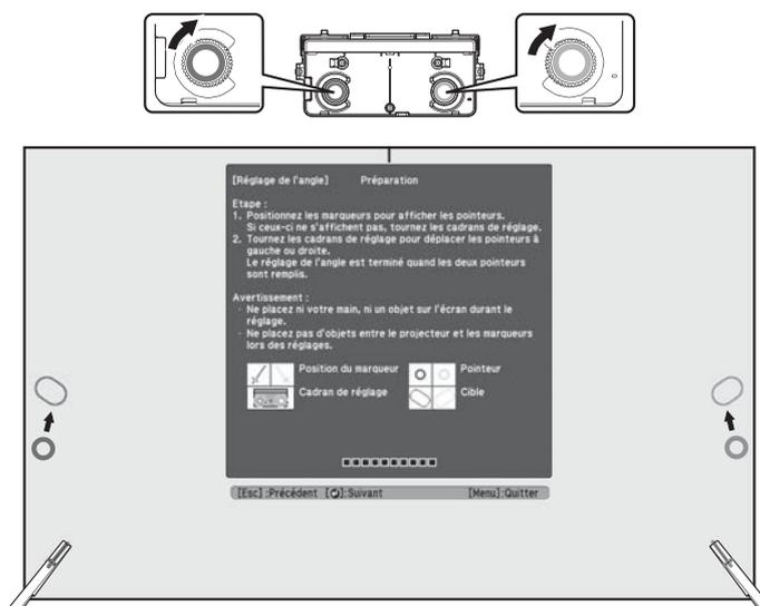
Lorsque vous tournez un cadran d'ajustement dans le sens contraire des aiguilles d'une montre, le pointeur se déplace à la diagonale vers le bas en direction opposée du centre de l'image projetée.
