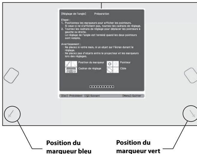
Faites correspondre les positions de sorte que les croix (1) soient superposées avec les points (2) sur les positions des marqueurs (X) (X). Déplacez le marqueur sur la croix projetée jusqu'à ce que les lignes de la croix soient alignées avec les lignes du marqueur.
