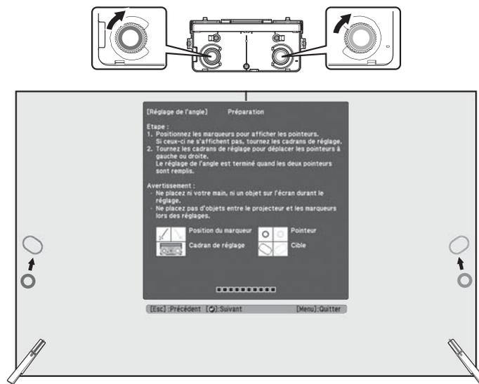
Lorsque vous tournez un cadran d'ajustement dans le sens contraire des aiguilles d'une montre, le pointeur se déplace à la diagonale vers le bas en direction opposée du centre de l'image projetée.
