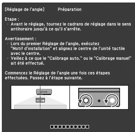
6. Tournez les cadrans de réglage de l'unité tactile dans le sens inverse des aiguilles d'une montre jusqu'à ce que vous entendiez un clic. Puis, appuyez sur le bouton ↻ de la télécommande.
