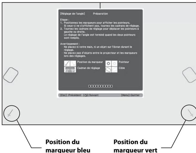
Faites correspondre les positions de sorte que les croix (①) soient superposées avec les points (②) sur les positions des marqueurs (↙) (↘). Déplacez le marqueur sur la croix projetée jusqu'à ce que les lignes de la croix soient alignées avec les lignes du marqueur.
