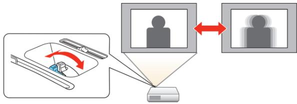
5 Si votre image ressemble à ou à , le projecteur est décalé vers un côté ou l'autre par rapport au centre de l'écran. Utilisez la glissière horizontale sur le projecteur pour corriger le décalage. Ou placez le projecteur tout à fait droit devant le centre de l'écran; le projecteur doit être placé perpendiculairement par rapport à l'écran.
