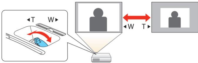
4 Faites tourner la bague de mise au point jusqu'à ce que l'image soit nette.
