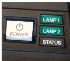
\* 图片显示配有超高压汞灯的投影机背面板。
