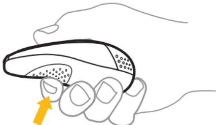
**15** Insérez l'émetteur-récepteur USB dans le compartiment de stockage USB. Poussez doucement dessus jusqu'à ce qu'il s'enclenche. Repousser doucement dessus pour le libérer.
