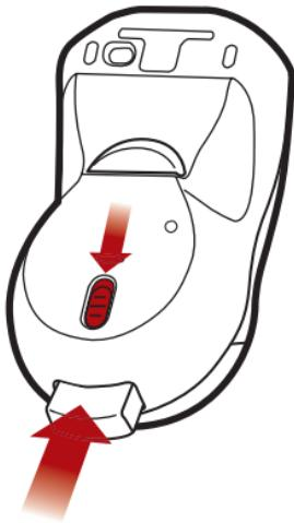
**15** Inserte el receptor USB en el compartimento de almacenamiento USB. Presione ligeramente hasta que encaje en su lugar. Presione ligeramente de nuevo para liberarlo.
